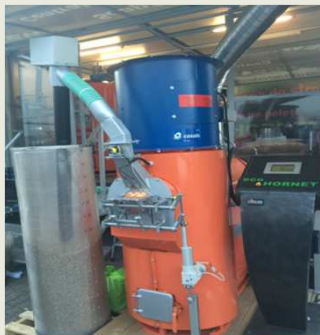
GHP 35kw, 3000 m 3 /h la 70 C
