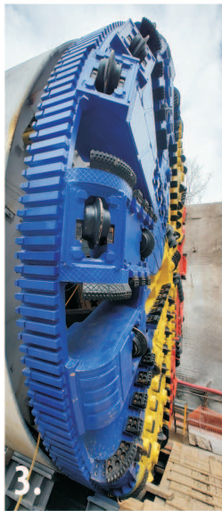
3. Brașov-Sighișoara - subsecțiunea 2, Apața-Cața - un TBM care forează în munți are 9,6 m diametru
